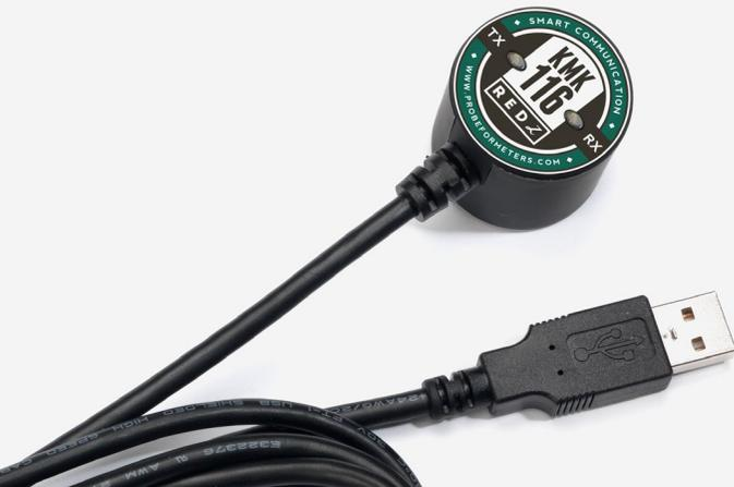
La REDZ KMK116 è una sonda ottica progettata in conformità alla norma IEC 62056-21 ed è compatibile con tutte le marche e i tipi di contatori omologati IEC. La sonda dispone di un connettore USB Maschio di tipo A, per cui può essere utilizzata con portatili e altri dispositivi compatibili.
