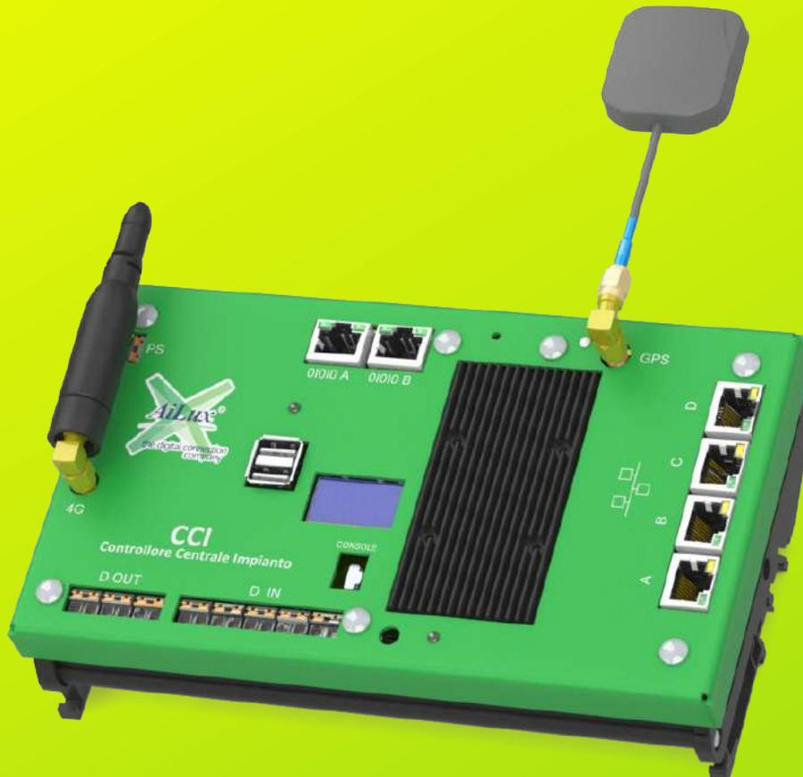
Il CCI è un Gateway per il monitoraggio di impianti di Produzione. Apparato prescritto da ARERA con delibera 36/2020/R/EEL e descritto dalla norma CEI 0-16 V1 del 2020 e V2 del 2021 negli allegati O e T. Raccoglie tutte le informazioni dell'impianto e le trasmette in modo sicuro al Distributore (DSO) o ad altro Operatore abilitato. Per ottemperare al regolamento le prestazioni del CCI secondo la specifica funzionale devono svilupparsi come segue:
